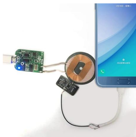
1.6 - сурет – Qi стандартында жасалған сымсыз қуаттандыру құрылғысының сұлбасы
